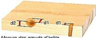
Mesure des nœuds d'arête (sur la face : \varnothing = d1 ; sur la rive : \varnothing = d2 )
